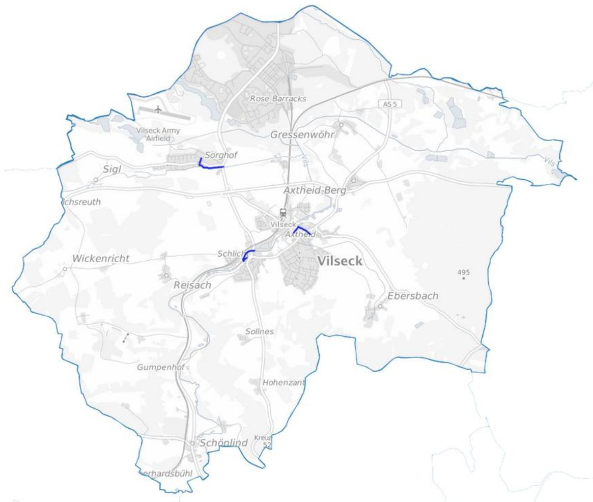
Abbildung 37: Abwassernetz gefiltert nach Abschnitten mit Höhe und Breite größer 800 mm (Veröffentlichung nach WPG, Anlage 2, II.)
